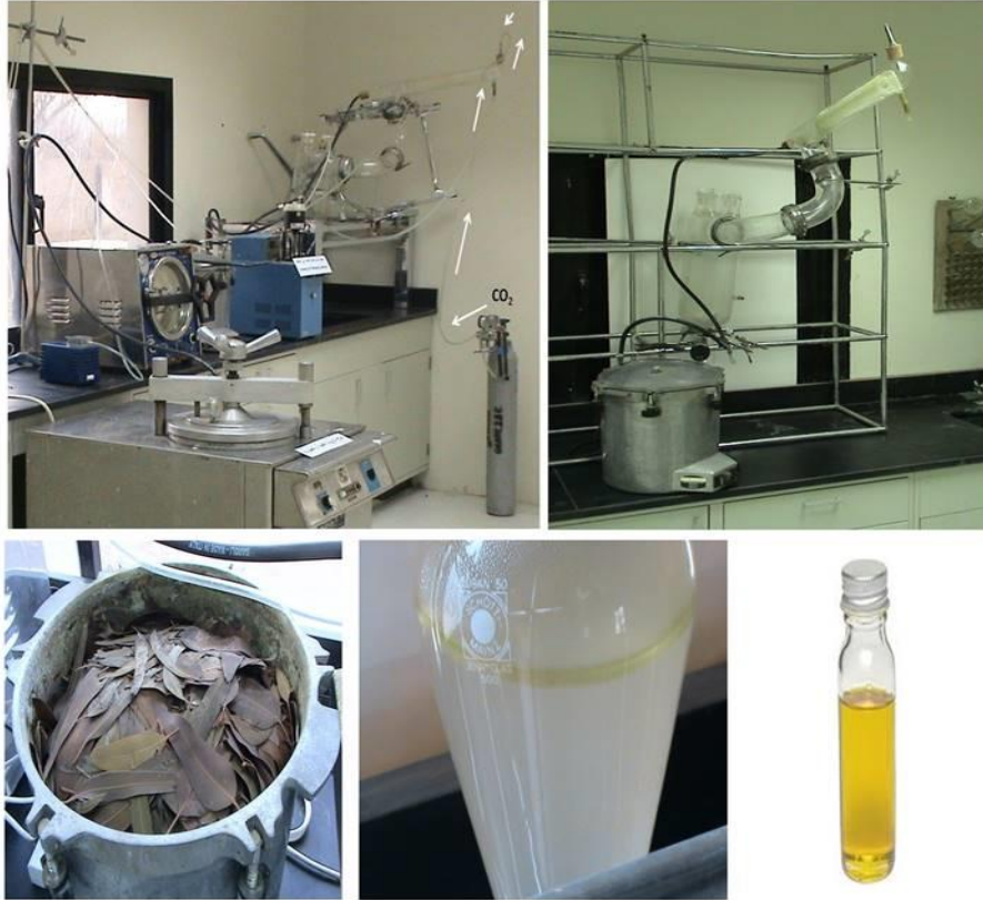
شكل رقم 10. جهاز الإستخلاص البخارى لإستخلاص الزيوت الطيارة من النباتات الطبية والعطرية
